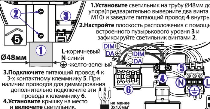
Момент затяжки: винт М10 28-35 Н\*м
