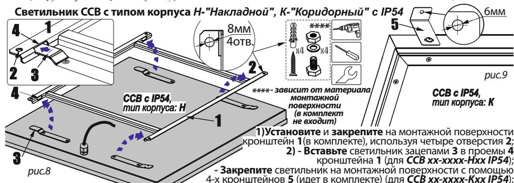
1) Установите и закрепите на монтажной поверхности кронштейн 1 (в комплекте), используя четыре отверстия 2;
