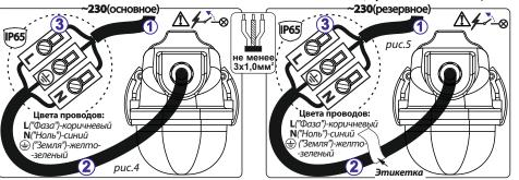
При включении резервного питания светильника происходит зарядка аккумулятора блока аварийного питания. Время полного заряда аккумулятора после первого включения - 12 часов.
