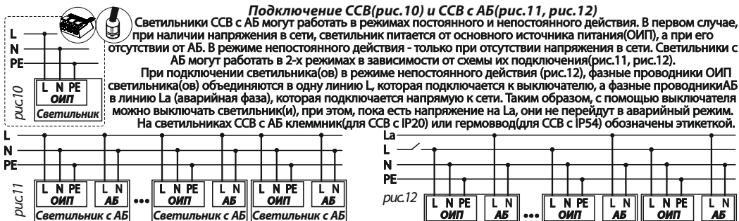
Подключение светильника(ов) ССВ с АБ для работы в постоянном режиме. Цвета проводов:***** L("Фаза")-коричневый N("Ноль")-синий PE("Земля")-желто-зеленый
