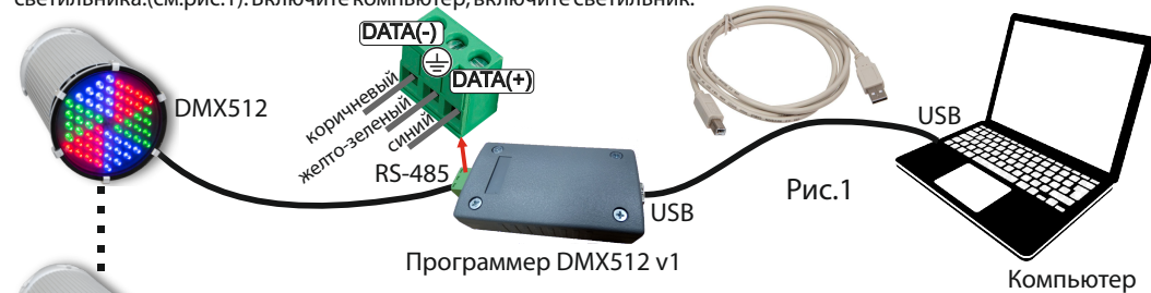
Схема подключения светильника с DMX512 для его конфигурации
