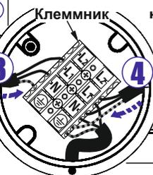
7) Подсоедините жилы кабеля 3 и 4 (для варианта б), см. выше) светильника к контактам контактной колодки и заземления: - заземление (желто-зеленый провод), L (коричневый) — фаза, N (синий) — ноль. Подключите к наружному соединительному контактному зажиму 5 для заземляющего проводника защитное заземление;
