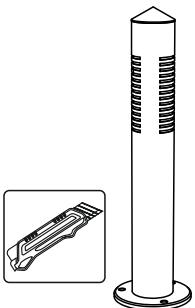
**1. Установите FGL основу 1** (не во всех модификациях) на опору, основание и закрепите ее с помощью болтов, винтов (в комплект не входят), предварительно заведите через отверстие 2 питающий кабель 3 для подключения светильника.
