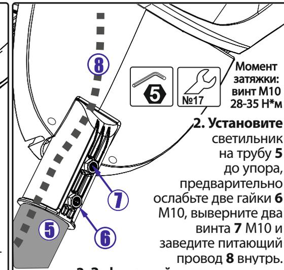
2. Установите светильник на трубу 5 до упора, предварительно ослабьте две гайки 6 M10, выверните два винта 7 M10 и заведите питающий провод 8 внутрь.
